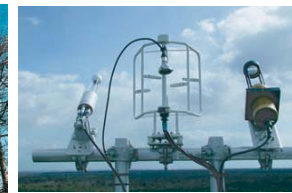
観測塔頂部に設置されている フラックス観測機器類 3成分超音波風向温度計ブローブ CO 2 濃度変動計 (Open-path法) Closed-path法用空気採取口
