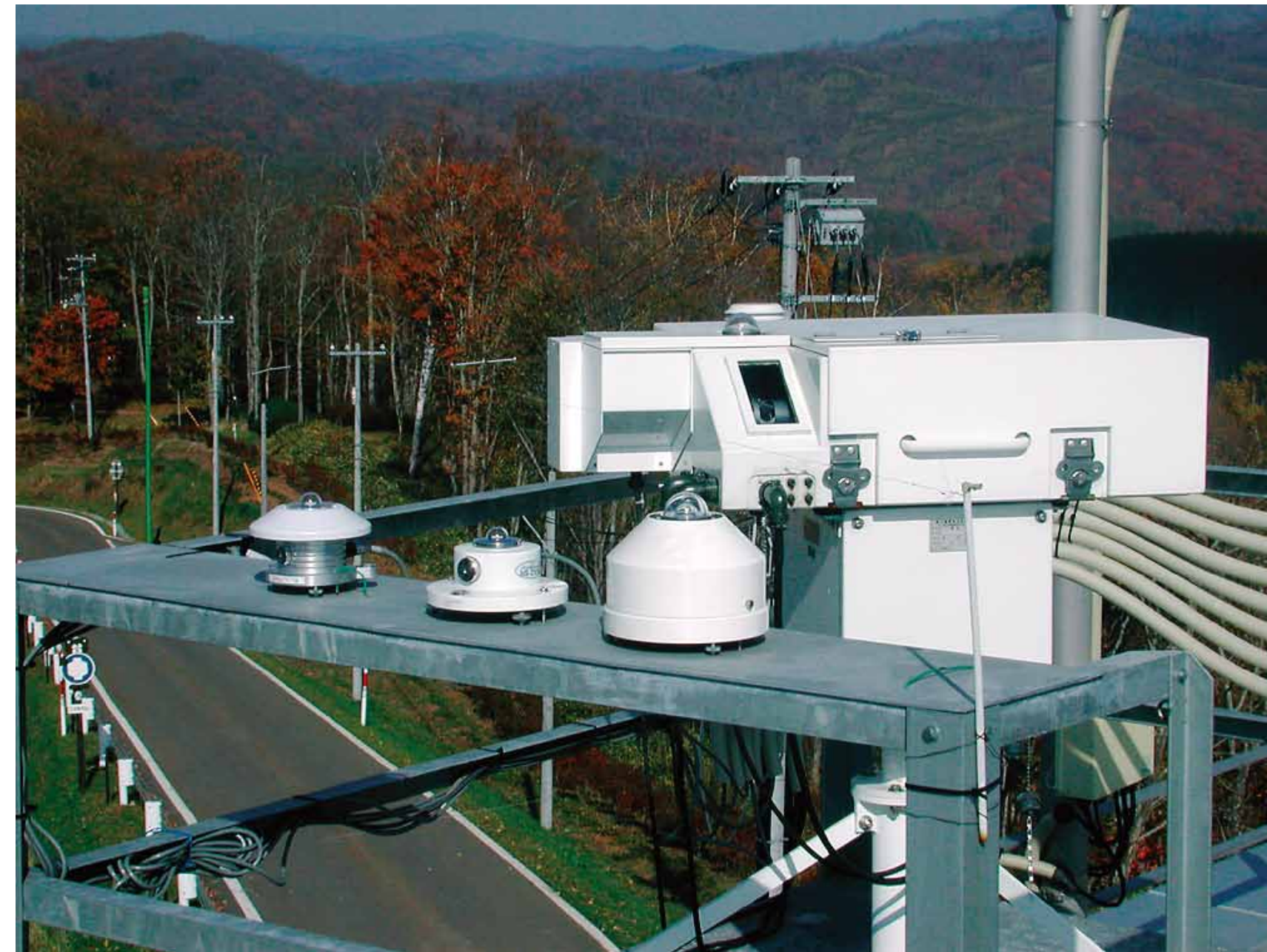
帯域型紫外線計群(手前)と分光型紫外線計(後)(北海道陸別町)
