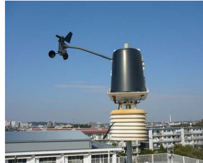
電子百葉箱ウェザーモニター II (Davis) センターユニット (Davis)
